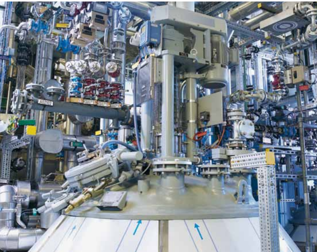
Die interseal dry9000® auf einem emaillierten Rührwerk.
